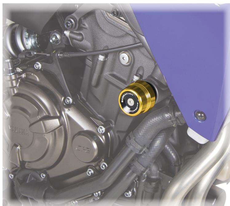
INDIVIDUARE I PUNTI DI FISSAGGIO SULLA MOTO E SMONTARE ESEGUENDO L'OPERAZIONE UN LATO PER VOLTA;
