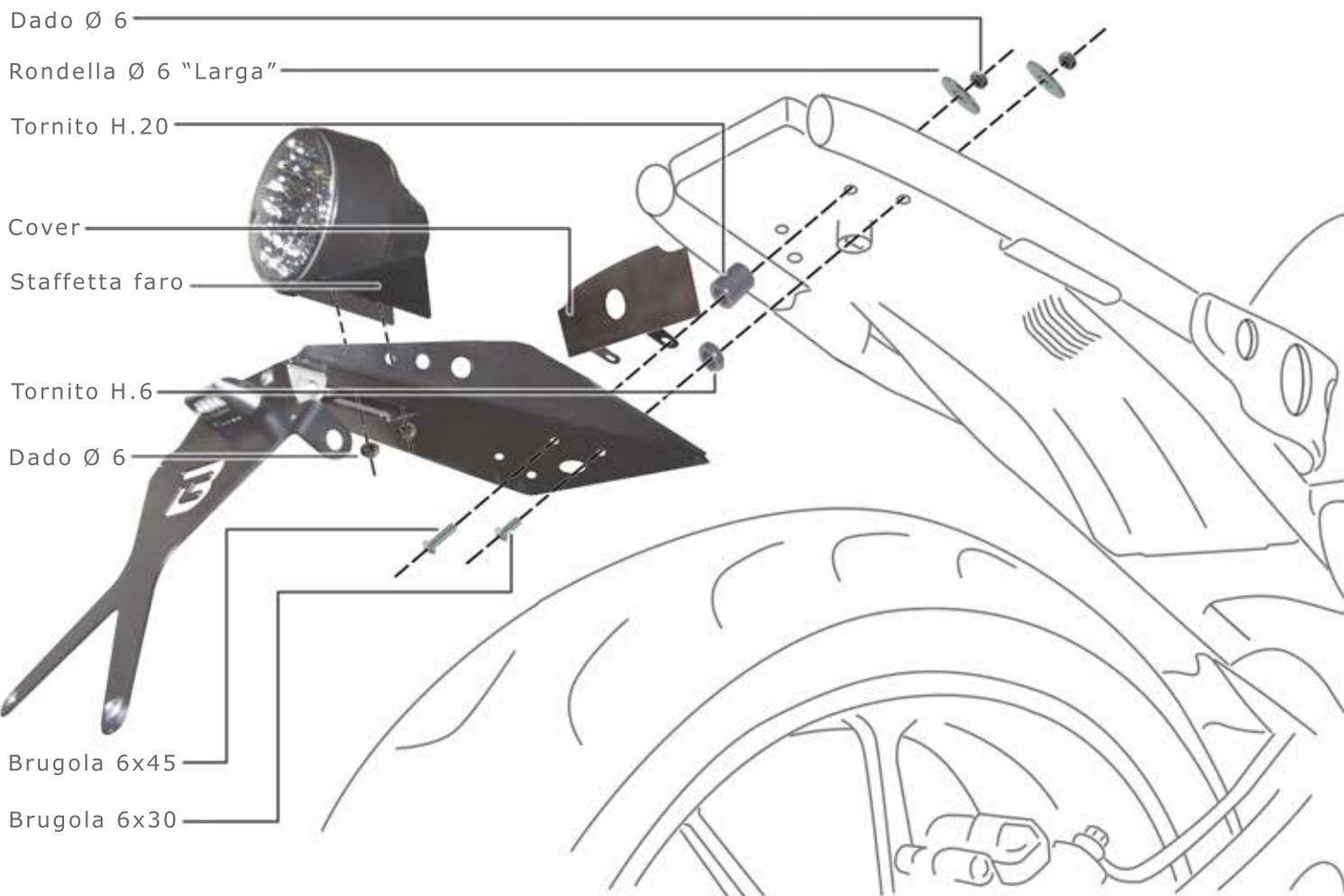
NOTE: SI CONSIGLIA, DI MANTENERE UN INCLINAZIONE NON SUPERIORE A 30° PER NON INCOMBERE IN SANZIONI DEL CODICE DELLA STRADA E PER EVITARE POSSIBILI ROTTURE STRUTTURALI
